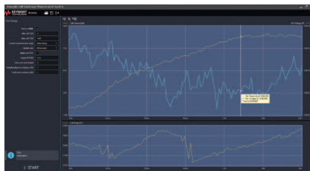
Результат теста на BT2191A для "годной" батареи. 1-канальная система измерила стабильный ток саморазряда в 9,08 мкА за ~1,5 часа.
