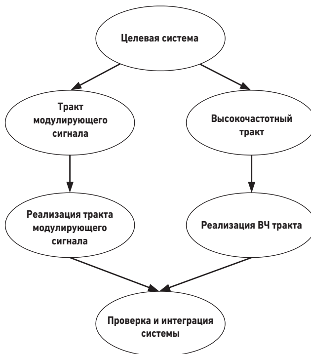
Рис. 3.1. Процесс проектирования типовой радиосистемы делится обычно на процессы проектирования двух подсистем: тракта модулирующего сигнала и ВЧ тракта.
