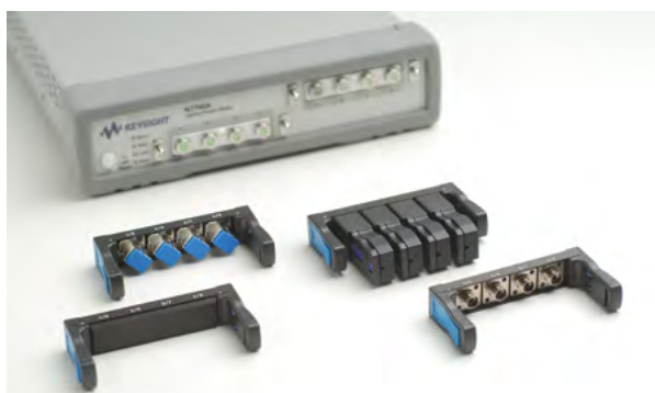
Многопортовый измеритель оптической мощности N7745A с интерфейсами N7740ZI, N7740FI, N7740BI, N7740KI (слева направо) для одновременного подключения 4-х соединителей
