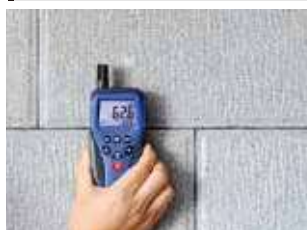
Измеряйте влажность строительного материала с помощью бесконтактной технологии
