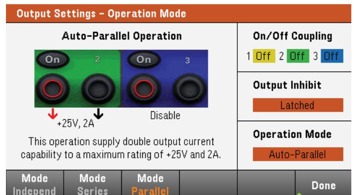
Рисунок 4. Функция автоматического параллельного включения позволяет удвоить выходной ток
