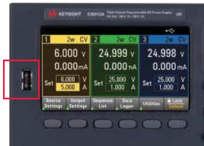
Рисунок 7: Порт USB на передней панели
