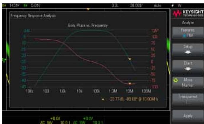
Измерение и построение зависимости коэффициента передачи от частоты любой схемы в диапазоне от 20 Гц до 20 МГц.
