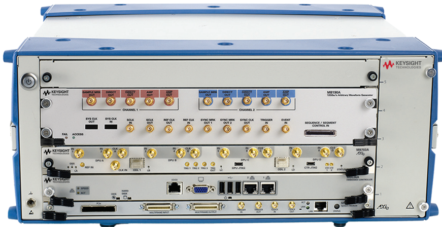
Генератор сигналов произвольной формы M8190A в формате AXIe, дигитайзер в формате AXIe M9703A в шасси в формате AXIe M9505A на 5 слотов
